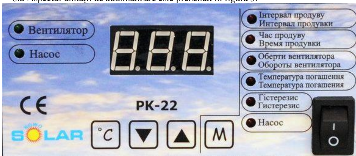
Figura 3 - Aspectul panoului frontal al controlerului
