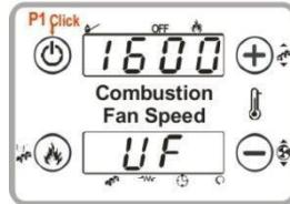
UF = Viteza ventilatorului [RPM/Volt]
